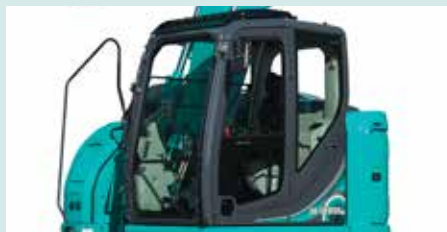
Standaard voorzien van beugels voor vandalisembescherming (neem contact op met uw KOBELCO-dealer voor het plaatsen van vandalisembescherming- of steenslagbescherming).
